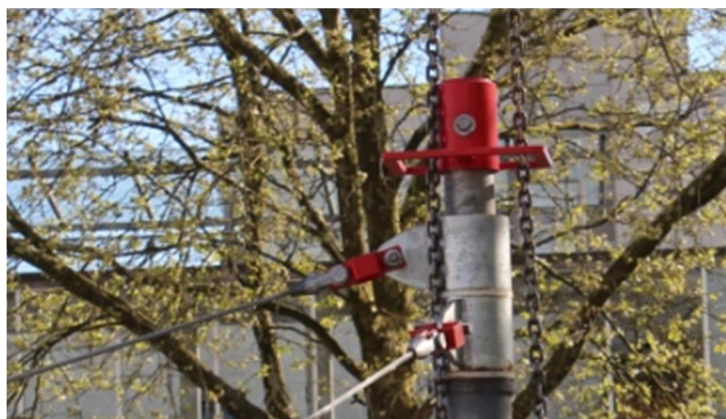
Seitliche Ansicht mit eingefahrener Krankette durch das Kammblech (rot)
